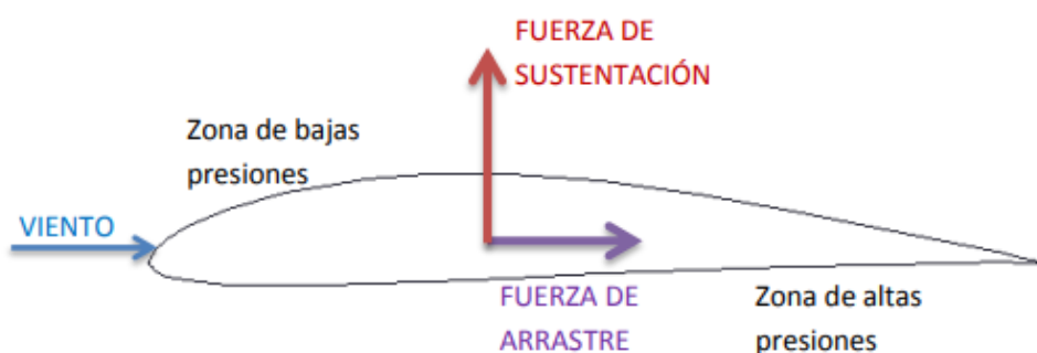
Figura 9. Comportamiento aerodinámicos de las palas de un aerogenerador (Fuente: [16])
